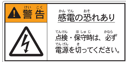
F 8 感電警告点検ラベル
